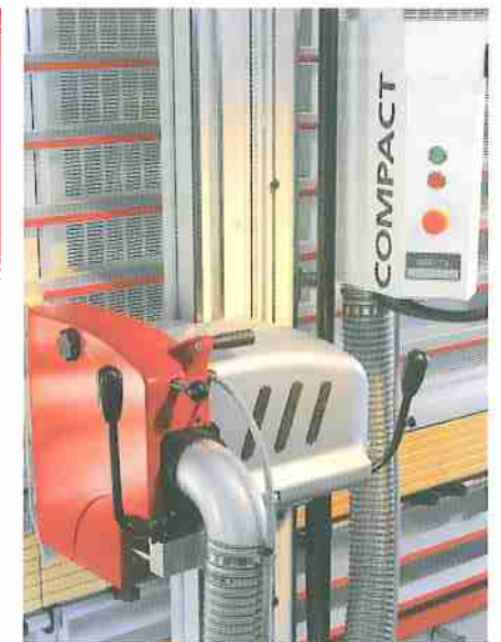
Im "klassischen, preisgekrönten" Striebig-Design: Sägeaggregat und Steuerkasten der COMPACT.
